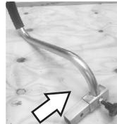
Insira o adaptador fornecido dentro da alavanca de flexão conforme foto ao lado
